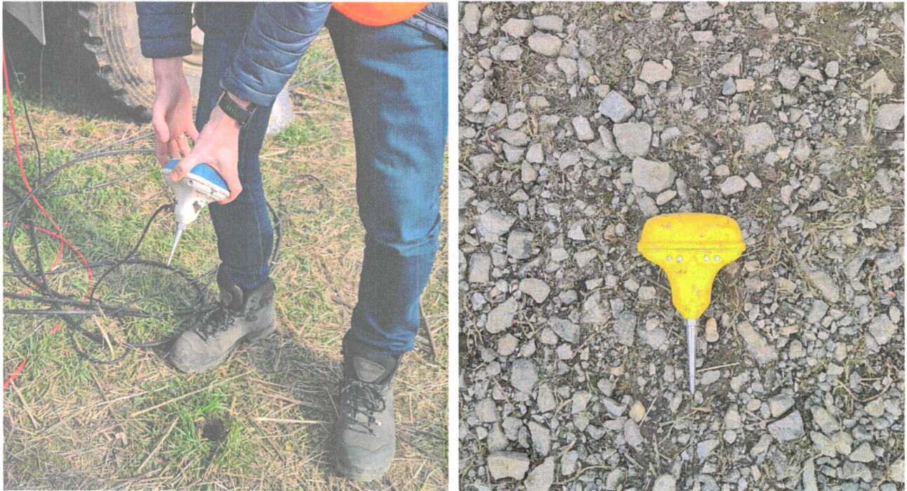
Slika 5. Prikaz geofona (prijamnika)
