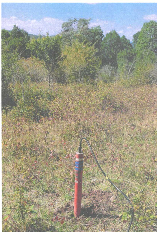
Slika 6. Prikaz sondi koje se koriste pri magnetotelurskom snimanju
