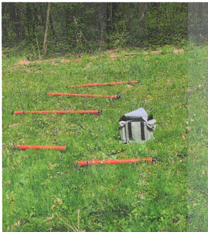
Slika 6. Prikaz sondi koje se koriste pri magnetotelurskom snimanju
